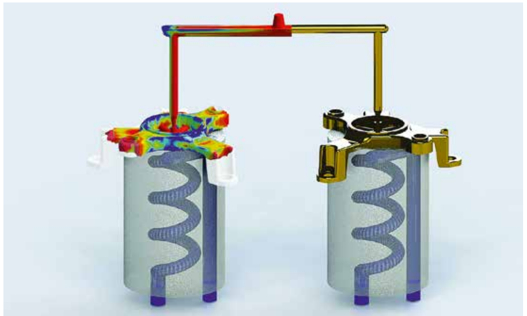
Bild 1. Motorenlagerung aus einem glasfaserverstärkten (30%) PA 66. Simuliert wird die Faserorientierung (Bild: Kalypso Ultra Technologies, Sigma Engineering)
